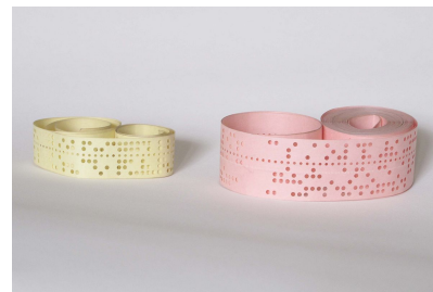
Figura 2: Esempari di nastro carta perforato, larghezza 5 (giallo) e 8 (rosa) fori.
